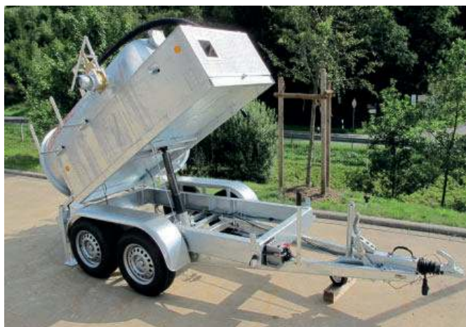
傾斜角度調整可能バキュームタンカー
